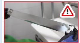
7º La cuchilla siempre se manipula por los dos extremos con los guantes anticorte puestos.
