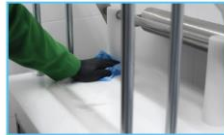
5º Limpiar base de la máquina. Para limpiar la parte de arriba de la máquina, pulverizar siempre el producto sobre un papel.
