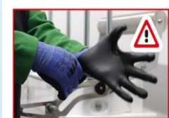
1º Ponte los guantes anticorte antes de limpiar la cuchilla.
