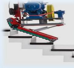
Mejora seguridad tiendas. Máquina sube escaleras, para mantenimiento de apoyo (GMA). Se recibirá en talleres entre septiembre y octubre. Se formarán los Coordinadores de Mantenimiento y los GMA. Ayuda a transportar cargas superiores a 150Kg.
