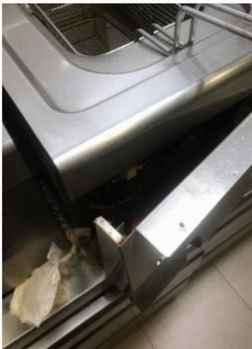
Freidora mal sellada (en anteriores informes ya se mencionó este problema y seguimos igual) La foto habla por sí sola. Además, no se puede poner a máxima potencia porque hace cortocircuito y se apaga constantemente. El cocinero/a tiene que arreglarlo tocando los cables siendo un grave peligro para la salud del trabajador/a.
